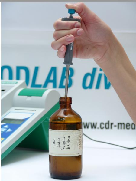
Avant de prélever l'échantillon, agiter toujours par inversion le récipient et plonger dans l'échantillon l'embout en pressant le piston.
