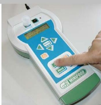
Encender el Minifood y cuando termina de calentarse, introducir la cubeta con el reactivo en la celda de incubación por 3-5 minutos. Cuando termina de calentarse la probeta, para efectuar el test de la Acidez Baja (para aceites de hasta 1.1% de aceidez) apretar la tecla **ACID**, apretar nuevamente la tecla **ACID** para la Acidez Alta (para aceites de 1.1% a 2.2% de acidez).
