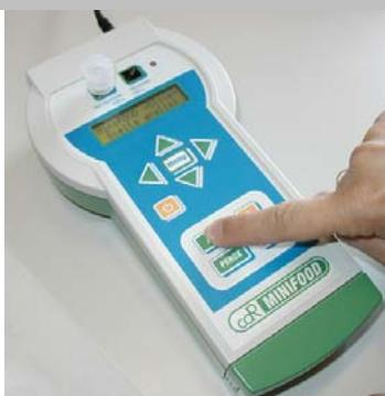
Allumer le Minifood et à la fin de la phase de chauffage insérer la cuvette avec le réactif dans la celle de thermostatation pour 3-5 minutes.
