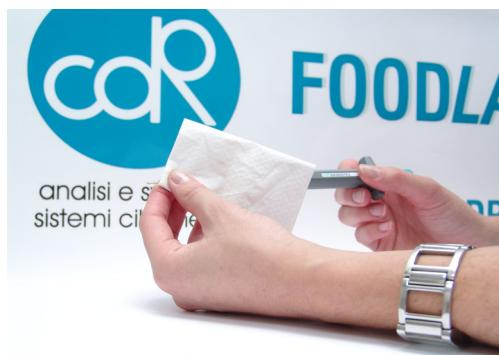
La nettoyage du embout est fondamental pour une analyse correcte:
