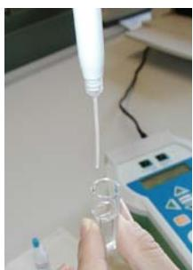
Plonger l' embout dans le liquide de la cuvette et "pomper" 3-4 fois en enlevant et abaissant avec le pouce le piston de la pipette.
