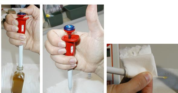
Immergere il puntale con il pollice abbassato. Alzare lentamente il pollice mantenendo il puntale immerso nel campione. Pompettare due o tre volte. Prelevare con l'apposito puntale 2.5  $\mu$ l di campione per l'Acidità Bassa o 1.25  $\mu$ l per l'Acidità Alta. Estrarre la pipetta con il pollice alzato.
