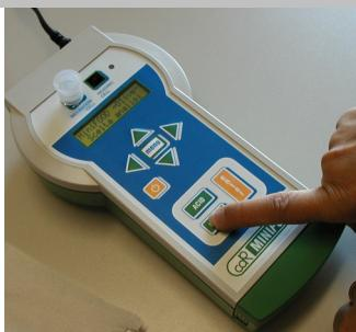
Accendere il Minifood e al termine del riscaldamento, inserire la cuvetta con il reattivo nella cella di incubazione per 3-5 minuti. Al termine del riscaldamento della provetta, per effettuare il test dei Perossidi premere il tasto **PEROX**.
