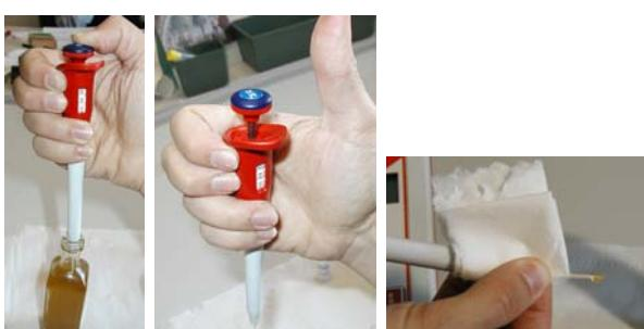
Plonger l' embout avec le pouce abaissé. Enlever lentement le pouce en tenant l' embout plongé dans l' échantillon. Pomper 2-3 fois
