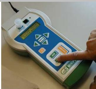
Encender el Minifood y cuando termina de calentarse, introducir la cubeta con el reactivo en la celda de incubación por 3-5 minutos.
