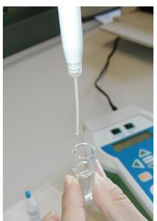
Immergere il puntale nel liquido della cuvetta e "pompettare" alzando ed abbassando il pistone 2-3 volte con il pollice.
