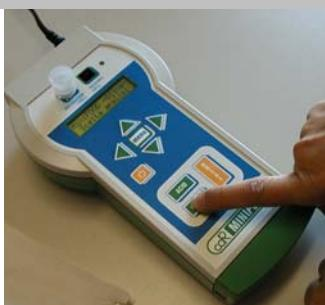
Allumer le Minifood et à la fin de la phase de chauffage insérer la cuvette avec le réactif dans la celle de thermostatation pour 3-5 minutes. À la fin du chauffage de l' éprouvette, pour effectuer le test des Peroxydes presser le touche **PEROX.**
