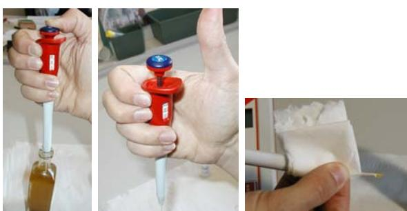
Plonger l'embout avec le pouce abaissé. Enlever lentement le pouce en tenant l'embout plongé dans l'échantillon. Pomper 2-3 fois. Prélèver avec l'embout approprié 2.5 µl d'échantillon pour l'Acidité basse ou 1.25 µl pour l'Acidité Haute. Lever la pipette avec la pouce enlevé.
