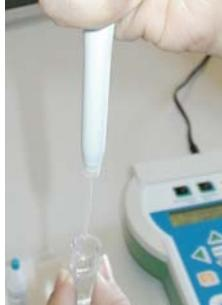
Sumergir la punta en el líquido de la cubeta y “pulverizar” subiendo y bajando el émbolo 2-3 veces con el pulgar.
