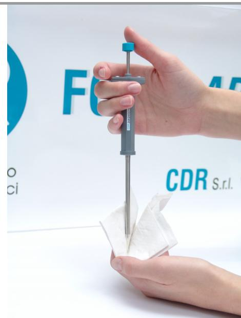
Ne pas toucher la pointe du embout avec le papier pour ne pas prélever l'échantillon à l'intérieur.
