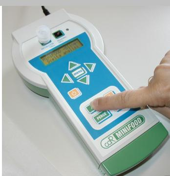
Accendere il Minifood e al termine del riscaldamento, inserire la cuvetta con il reattivo nella cella di incubazione per 3-5 minuti.
