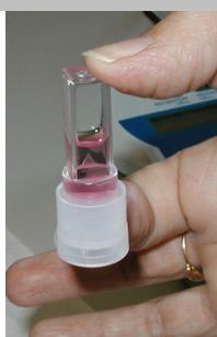
Immergere il puntale nel liquido della cuvetta e "pompettare" alzando ed abbassando il pistone 2-3 volte con il pollice.
