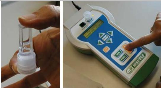
Agiter la cuvette par inversion, et la insérer dans la celle de lecture et presser **ENTER.**
