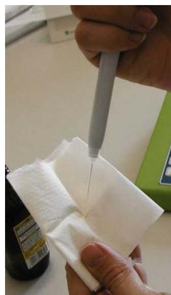
**No tocar la punta de la pipeta para no extraer la muestra de aceite del interior.**
