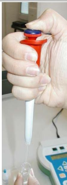
Plonger l' embout dans le liquide de la cuvette et "pomper" 2-3 fois en enlevant et abaissant avec le pouce le piston de la pipette.
