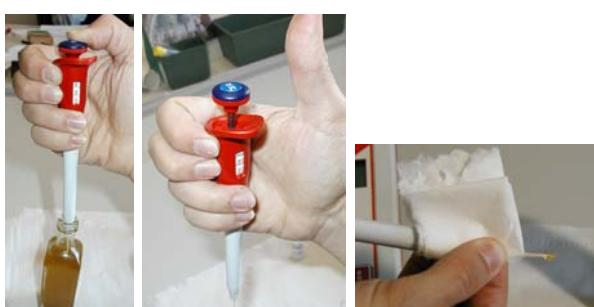
Sumergir la punta con el pulgar hacia abajo. Levantar lentamente el pulgar manteniendo la punta sumergida en la muestra. Pulverizar dos o tres veces. Extraer con la específica punta 2.5  $\mu$ l de muestra para la Acidez Baja o 1.25  $\mu$ l para la Acidez Alta. Extraer la pipeta con el pulgar levantado.
