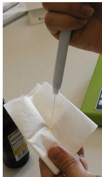
**Non toccare la punta della pipetta per non prelevare il campione di olio dall'interno.**
