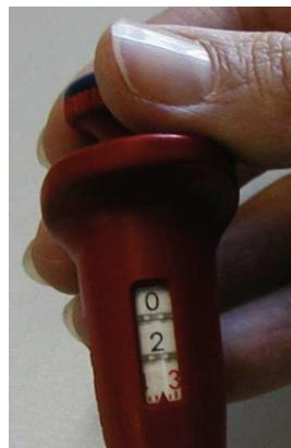
Prima di fare un'analisi, controllare che il volume della pipetta sia corretto.
