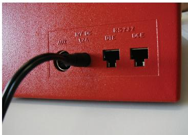
Accensione dello strumento: inserire lo spinotto ed attendere il caricamento delle analisi. Al termine del caricamento lo strumento si spegne.
