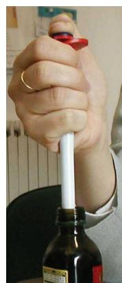
Al prelievo del campione, agitare sempre per inversione il contenitore con il campione e immergere il puntale tenendo il pistone abbassato
